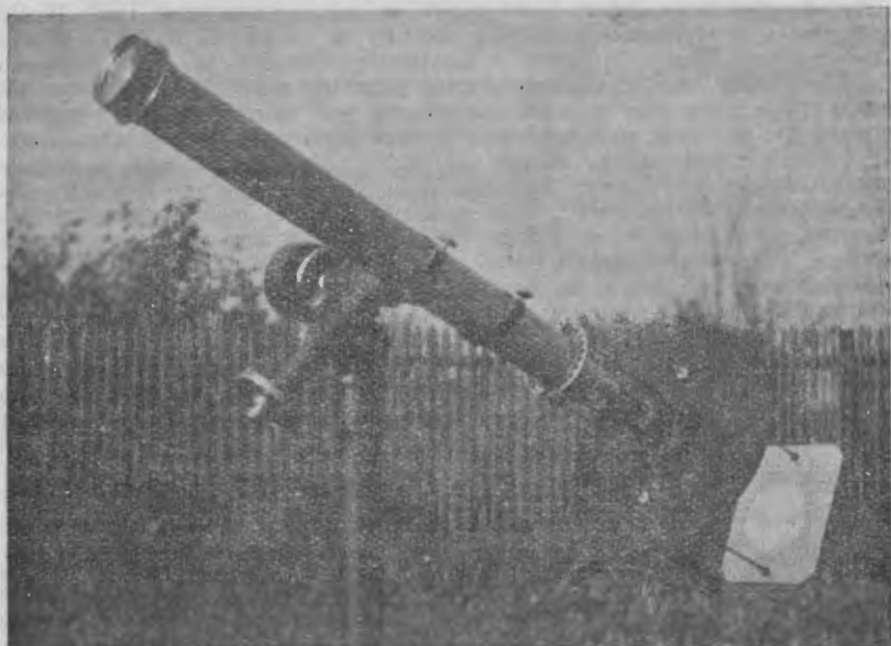
Fot. 1. Refraktor „Merz” o średnicy obiektywu 60 mm i ogniskowej 800 mm z ekranem słonecznym, za pomocą którego autor artykułu dokonuje obserwacji Słońca.
